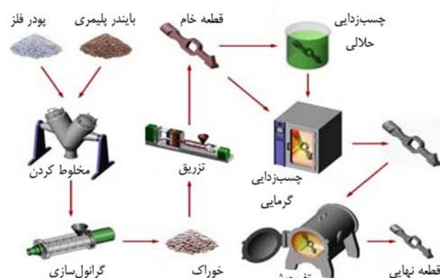
شکل ۷- مراحل مختلف تولید در فرایند قالب گیری تزريقی پودر [۱۴].
