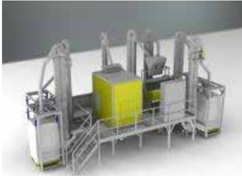
شکل ۳- جداساز PVC بر مبنای جداسازی الکتروستاتیکی و نوری [۷].
