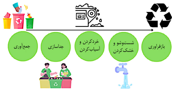
شکل ۳- بازیافت مکانیکی پسماندهای PVC [۴].
