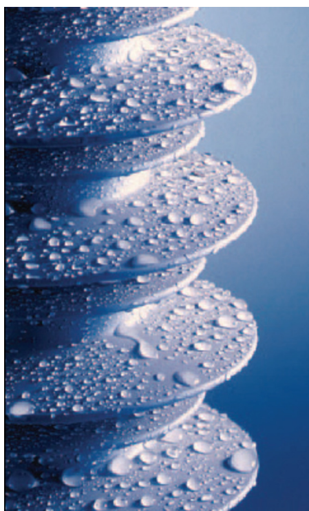
شکل ۴- مقره پوشش‌یافته با رزین سیلیکونی و پاشش قطرات آب روی سطح آن [۲۴].
