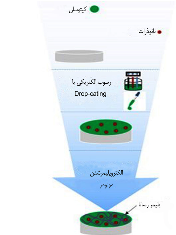
شکل ۳- نمایی از فرایند تهیه حسگرهای الکتروشیمیایی برپایه کامپوزیت کیتوسان [۱۸].
