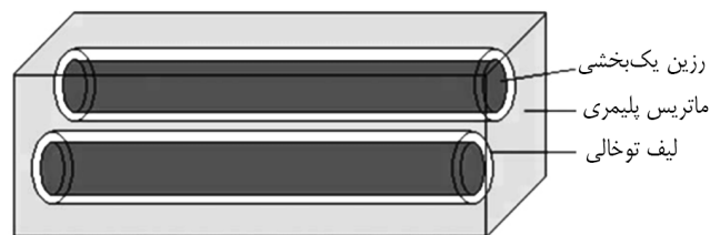
شکل ۴- سامانه خودترمیم رگ‌دار یک‌بعدی بر پایه لیاف توخالی شیشه که رزین ترمیم‌کننده درون آن‌ها جاگذاری شده است [۱۱].
