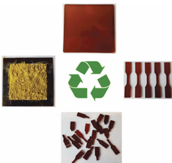
شکل ۸- چرخه بازیافت مکانیکی قطعه تولید شده با رزین اپوکسی ویتریمری [۹].
