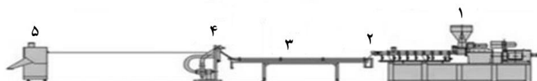
شکل ۴- خط کامل تولید مستریچ شامل: ۱-قیف دستگاه ۲- قالب (حدیده) ۳- تانک آب ۴- خشک کن ۵- خرد کن [۱۱].
