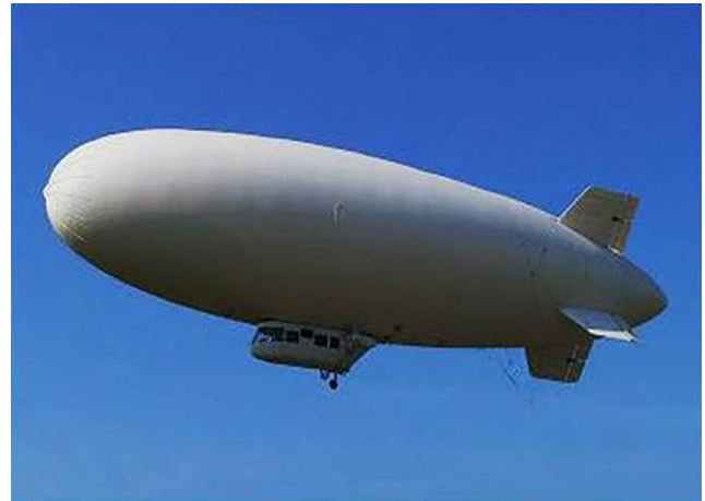
شکل ۴- کشتی هوایی معمولی دارای گوندولا، وسیله نقلیه باموتور و بدون اتصال [۱۱].
