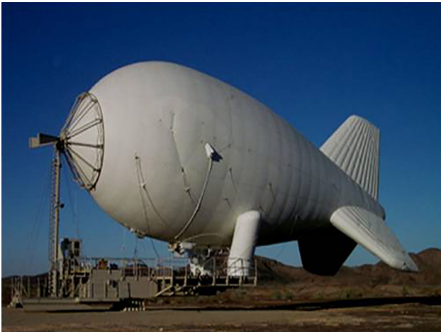
شکل ۳- هواایست معمولی، سامانه نقلیه بی‌موتور و دارای اتصال [۷].
