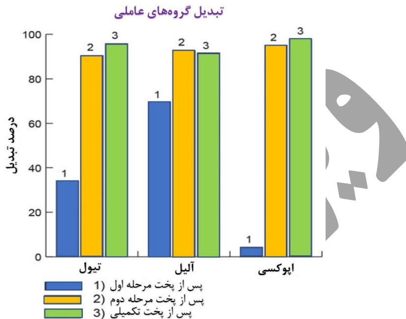
شکل 13: درصد تبدیل هر یک از اجزای تیول، اپوکسی و آلیل پس از مراحل مختلف پخت [25].
