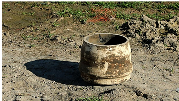
شکل ۷- لوله PVC حفاری شده پس از ۵۰ سال کاربرد در شهریار مغان [۲۹].
