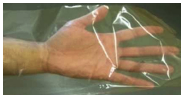
شکل ۶- فیلم شفاف و انعطاف پذیر کیتوسان-کورکومین با استفاده از کولین کلرید-لاکتیک اسید به عنوان نرم کننده [۲۰].
