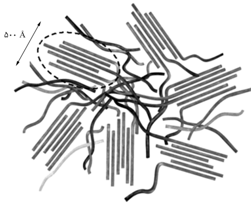
شکل ۷- مدل پیشنهادی میله برای شکل شناسی نفیون [۲].
