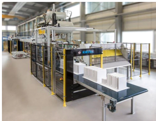
شکل ۷- دستگاه گرمایش دهی خودکار تولید بدنه یخچال [۸].
