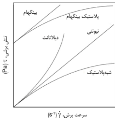
شکل ۱- منحنی رفتار سیال‌های نیوتنی و غیرنیوتنی مستقل از زمان [۱].
