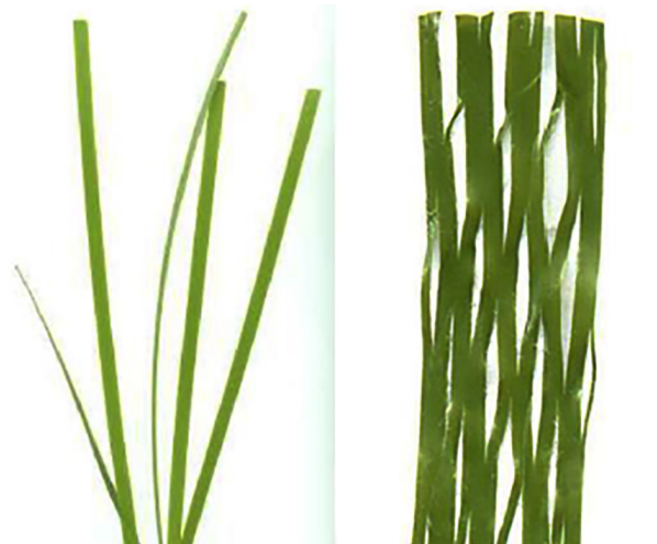
شکل ۲- الیاف به‌کار رفته در خاب چمن مصنوعی: (الف) الیاف لیفچه‌ای شده و (ب) الیاف تکرشته‌ای [۵].
