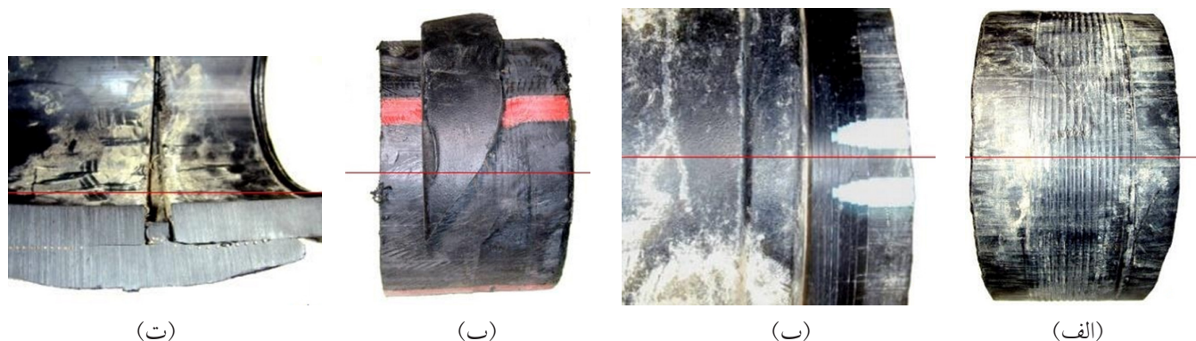
شکل ۶- مثال‌هایی از اتصال‌دهی نامناسب با جوش الکتریکی: (الف) عدم لایه‌برداری، (ب) لایه‌برداری بیش از اندازه، (پ) لایه‌برداری ناکافی سطح لوله در محل اتصال و (ت) عدم قراردهی مناسب لوله در جفت‌کننده [۱۴].
