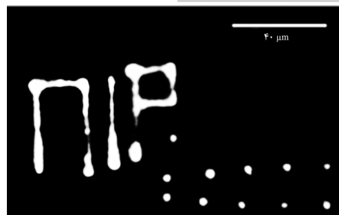
شکل ۲- تصویر فلئوئورسان نقاط پلیمر شده و خطوط کشیده شده روی شبکه سیلیکون با قلم نانو به همراه مخلوط نقش بسته دار شده شامل الگوی فلئوئورسان [۱۱].
