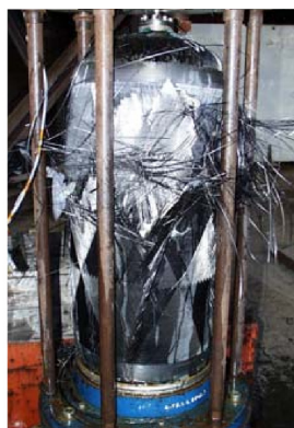
شکل ۷- نمونه در مقیاس کوچک برای شناسایی خواص مکانیکی و آزمون انفجار شدید [۱۸].
