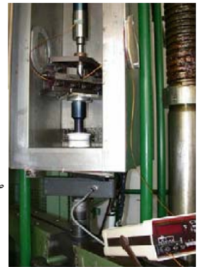
شکل ۴- پیکربندی آزمون SBS (ASTM D2344) [۱۸].
