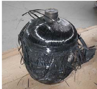
شکل ۶- مخزن کوچک پیش و پس از آزمون انفجار شدید [۱۸].
