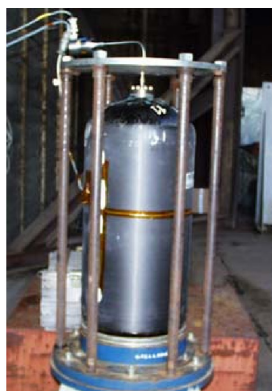
شکل ۷- نمونه در مقیاس کوچک برای شناسایی خواص مکانیکی و آزمون انفجار شدید [۱۸].
