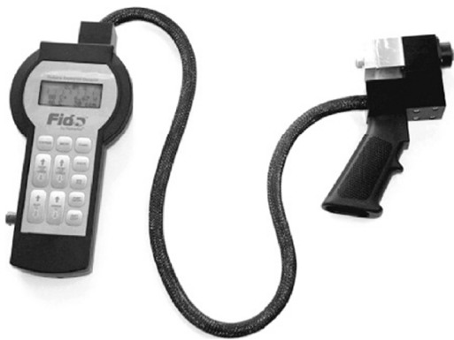
شکل ۷- شناساگر دستی مواد منفجره بر اساس فناوری پلیمر فلئورسان تقویت‌کننده، با نام تجاری Fido ساخت شرکت ICx Technologies [۲۳].
