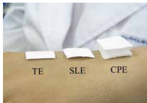
شکل ۷- مقایسه ضخامت داربست‌های تولید شده با سه روش SLE، TE و CPE [۱۷].
