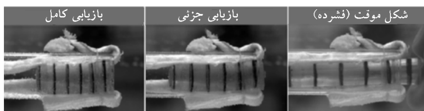
شکل ۷- دستگاه پلیمر حافظه شکلی استوانه ای شکل طراحی شده برای انبساط در دمای بدن. دستگاه داخل لوله شیشه ای با یک تاندون گاوی می شود و خود را با تاندون تنظیم می کند [۲۴].
