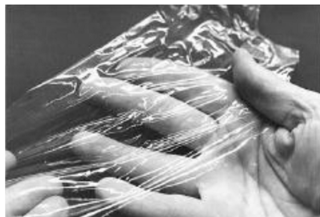
شکل ۶- غشای ساخته شده از پلی [بیس (بوتیل آمینو فسفازین)] برای جداسازی مایعات از یکدیگر [۳].
