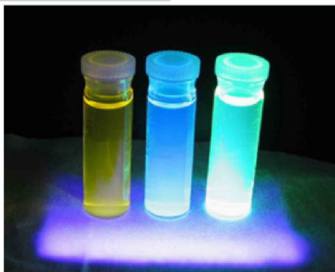
شکل ۱۱- پلی فسفازین با خاصیت الکترونورتاب، دارای کاربرد در صفحه های تلویزیون [۵۳].
