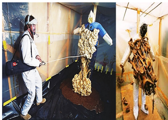
شکل ۸- آزمایش تفنگ اسفنج چسبان با افشانک استاندارد روی آدمک مصنوعی.
