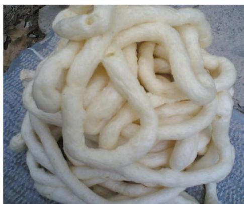
شکل ۴- اسفنج تهیه شده از مخلوط چسب فشاری با فرمول‌بندی بهینه (فرمول‌بندی ۸) و عامل پف‌دهنده HCFC-22 به همراه گاز کربن دی‌اکسید [۲].
