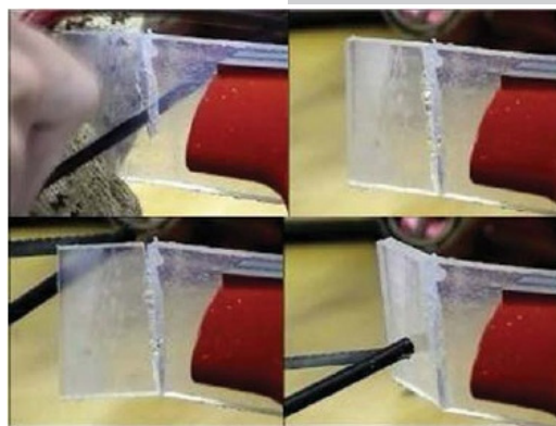
شکل ۹- ایجاد آسیب در فیلم یونومری با استفاده از اره. عکس‌های گرفته شده با گذشت زمان نشان‌دهنده انجام ترمیم به محض آسیب با اره است [۲۰].
