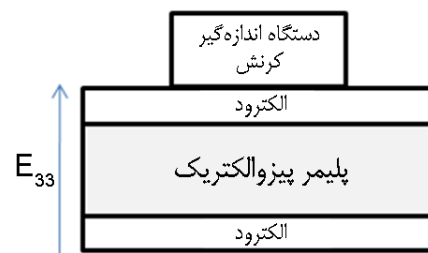
شکل ۷ - طرح‌واره‌ای از چگونگی انجام آزمایش برای اندازه‌گیری ضریب‌های پیزوالکتریک [۱۸].
