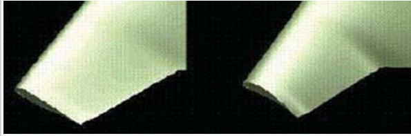
شکل ۴- بال با انحنا متغیر: حالت عادی طرح انحنا بال (سمت چپ) و انحنا ایجاد شده در بال (سمت راست) [۴].
