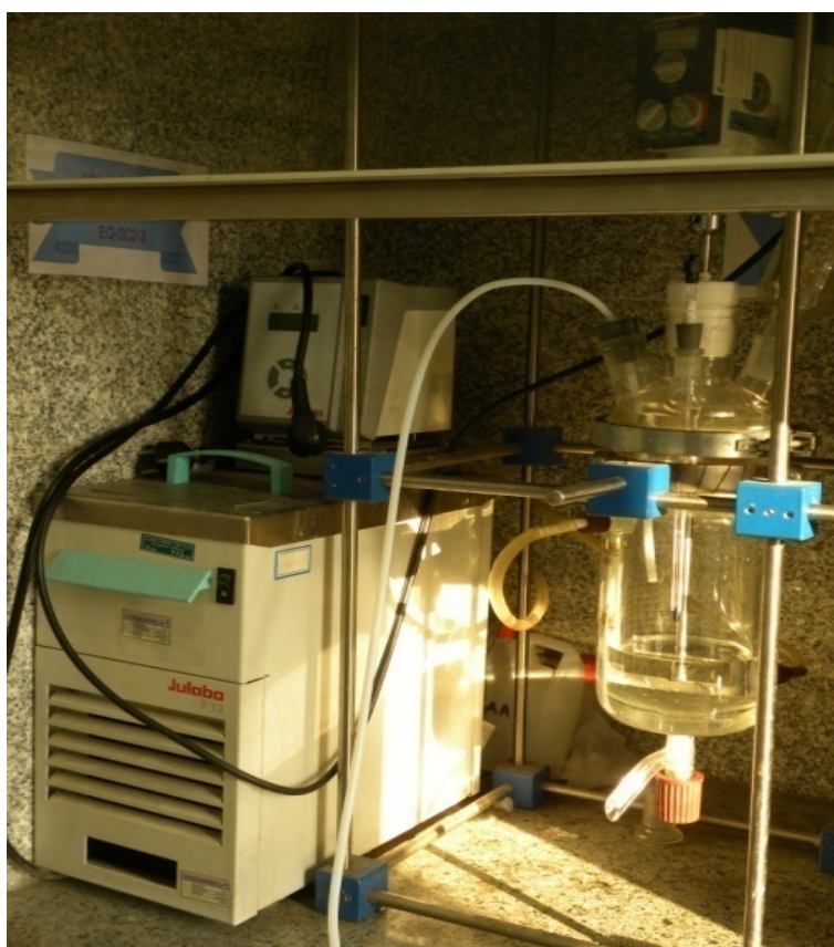
شکل ۱: راکتور شیشه‌ای یک لیتری استفاده شده.
